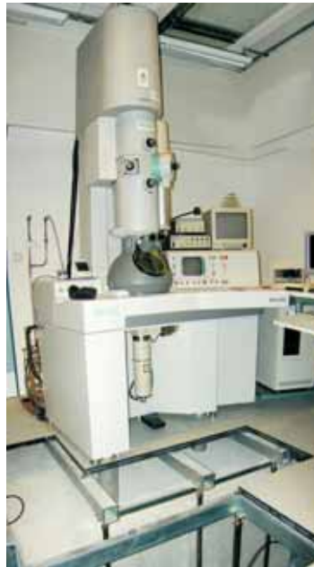
Abb. 1: Transmissionselektronenmikroskop auf pneumatischen Isolatoren in Unterflurtechnik
