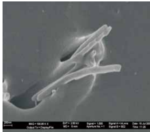
Abb. 2: Kohlenstoffnanofasern, einpolymerisiert in syndiotaktisches Polypropylen.
