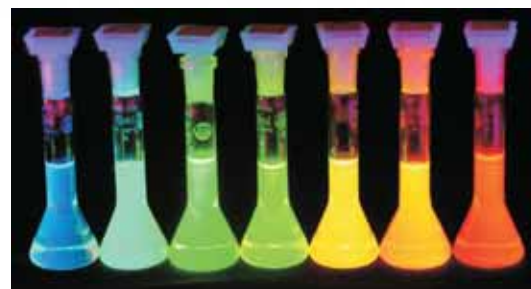
Abb. 2: Fluoreszenz von CdSe-Nanopartikellösungen. Die mittlere Größe der Partikel nimmt von 2.5 nm (blau) bis 6 nm (rot) kontinuierlich zu.
