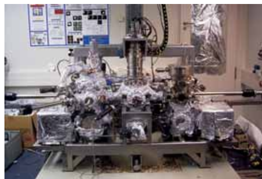
Abb. 3: Für extrem präzise Nanomanipulationen (z. B. Manipulationen einzelner Atome) wird ein mit flüssigem Helium gekühltes Rastersondenmikroskop aus der Arbeitsgruppe von Prof. Wiesendanger am Institut für Angewandte Physik verwendet. Das Mikroskop kann sowohl vor Ort als auch ferngesteuert vom Fachbereich Informatik betrieben werden.
