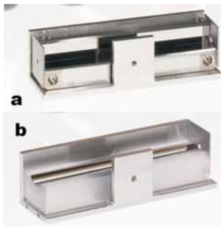
Abb. 3: Fokussierende Röntgenoptiken für Einkristalldiffraktometrie: (a) Montel, (b) SBM.
