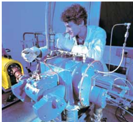
Abb. 1: Hochenergiemahlen zur Herstellung nanokristalliner Werkstoffe in technischem Maßstab.
