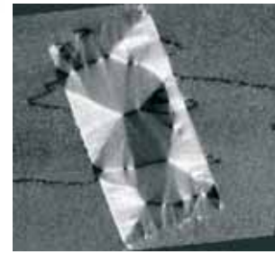
Abb. 2: SEMPA-Aufnahme des Domänenmusters in einer Co-Struktur auf \text{SiO}_2 . Die Probe wurde mittels Elektronenstrahlolithographie hergestellt. Zur Abbildung wurden ca. 10 Monolagen Eisen aufgedampft. Die kürzere Seite der Co-Struktur ist 10 \mu\text{m} lang.
