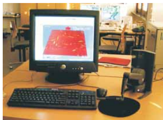
Abb. 1: Arbeitsplatz für Nanomanipulationen. Dieses System stellt eine Schnittstelle zur Übertragung von Manipulationsaufgaben in die Nanowelt dar. Manipulationen können per Hand oder vollautomatisiert ausgeführt werden.
