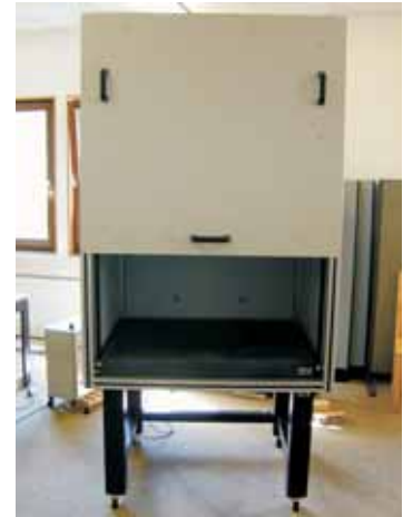
Abb. 3: Lichtdichter Faradaykäfig mit integrierter Schwingungsdämpfung
