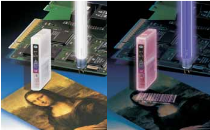
Abb. 1: Nano-Pigmente in der Anwendung beim Produkt- und Markenschutz. Unter Tageslicht sind die Pigmente farblos. Bei Beleuchtung mit UV-Licht fluoreszieren die Nano-Pigmente. Das Druckbild wird dabei erkennbar.
